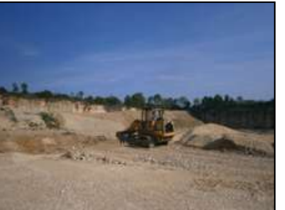
5/ Opération de gerbage réalisée par le chargeur sur chenilles
